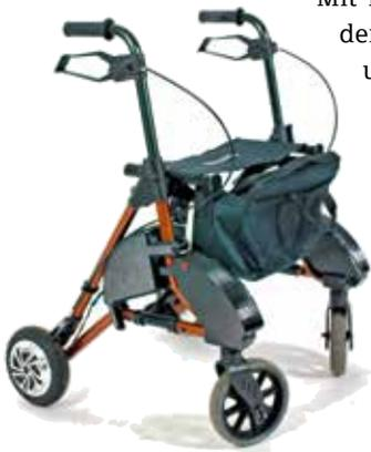
Mit Hilfe des Elektromotors unterstützt der RABE-Rollator bei längeren Strecken und bei Gefälle. Kurze Distanzen kann er autonom zurücklegen, etwa das Heranfahren ans Bett, was der Sturzprophylaxe entgegenwirken kann. Per Navigation kann er sich in der Pflegeeinrichtung und im Außenbereich orientieren. Die direkte Kommunikation zwischen Rollator und Pflegeeinrichtung ist hilfreich vor allem bei der Betreuung von demenzkranken Menschen.
